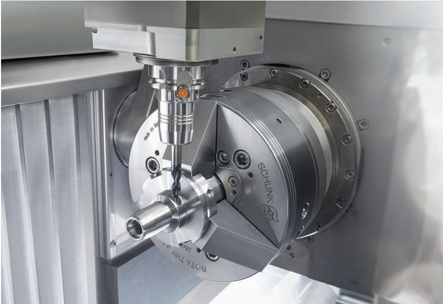
4 Der iTendo2 erkennt Werkzeugverschleiß durch veränderte Schwingungsmuster und informiert darüber während des Prozesses. Dadurch können Nutzer die Standzeit ihrer Werkzeuge optimieren © Schunk
